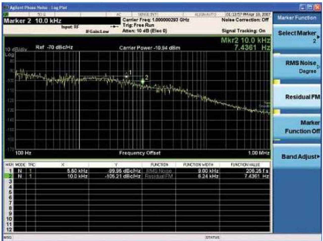
Рисунок 4: Вычисление среднеквадратичного (RMS) значения джиттера фазового шума, используя маркер полосы
