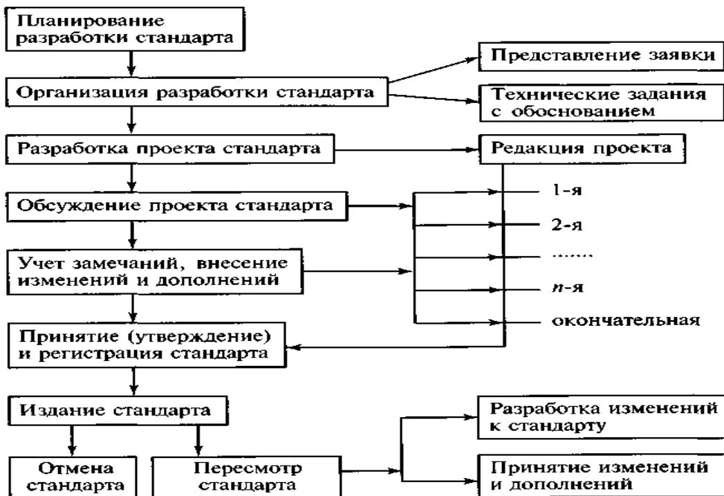
Рис. 7. Порядок разработки стандартов
